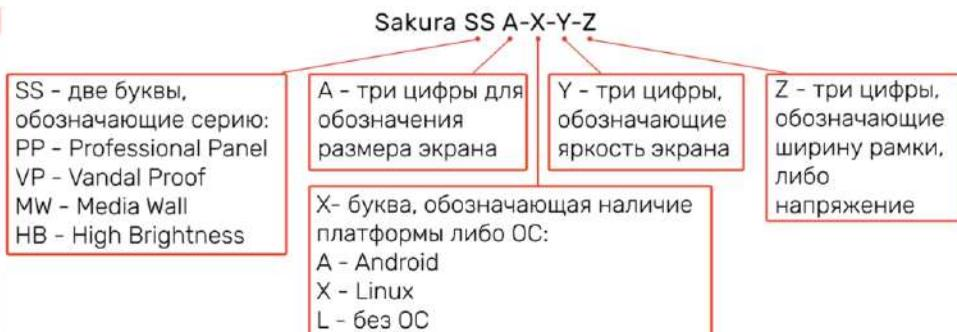
Пример: Sakura VP (D) 133A-300-12 расшифровывается, как вандало-защищенный дисплей (Vandal Proof [Display]) с экраном 13,3 дюйма, на контроллере с архитектурой ARM, яркостью экрана 300 сДл/м2 и напряжением питания 12 Вольт.
