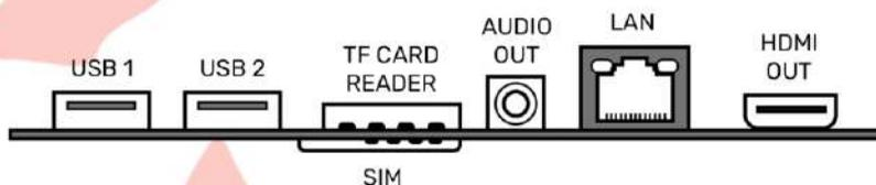
Вид интерфейсной части монитора оборудованных платформой RK 3288 (2Gb/8Gb)
